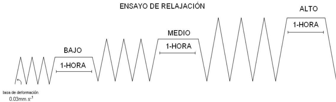
Figura 6.1: Esquema del protocolo de ensayo de relajación en 3 niveles de tensión, junto con los ciclos de acondicionamientos. Las señales de deromación en forma de diente de sierra se realizaron con rampas a una tasa de deformación ascendente y descendente de 0.03 mm/s.
